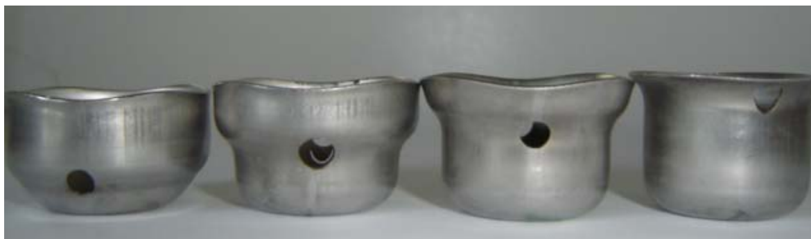
Figura 4.12: Exemplos de pré-formas da operação de reembutimento nas quais foram cortadas amostras das zonas de deformação.
