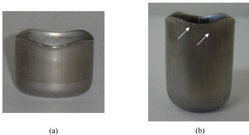
Figura 5.35: Copos conformados do aço 304N. Em (a) é visto o copo embutido e em (b) o copo reembutido que apresentou o fenômeno de Delayed Cracking após o período de observação de 24h. LDR-DC: >2,50.
