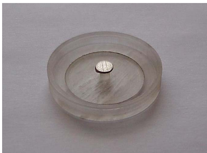
Figura 4.3: Porta amostra utilizado como suporte das amostras de aço inoxidável na Difração de Raios-X.
