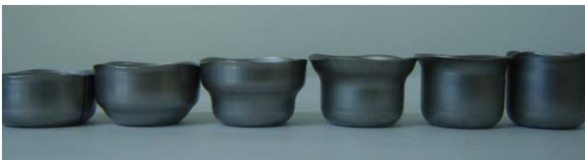
Figura 5.59: Estágios da operação de reembutimento dos aços inoxidáveis austeníticos.
