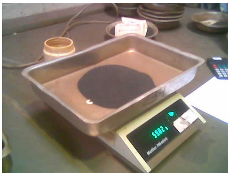
Figura 4.3 – Momento da pesagem das massas retidas de cada fração durante ensaio de análise granulométrica realizado no Centro de Tecnologia de Ferrosos da VALE (CTF).
