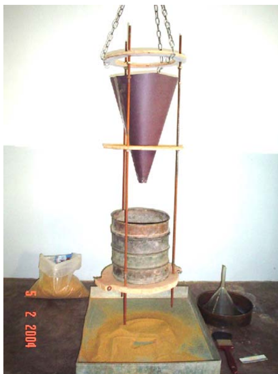
Figura 4.14: Foto do sistema de chuveiramento empregado
