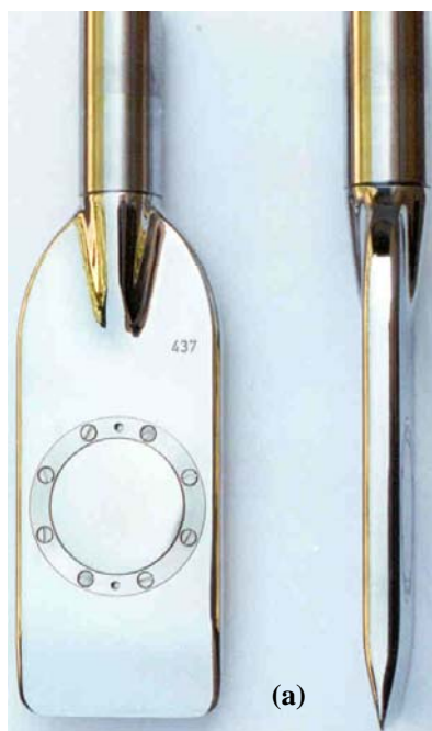
Figura 2.15: Aparato principal do DMT: a) lâmina dotada de membrana circular; b) unidade de controle e leitura
