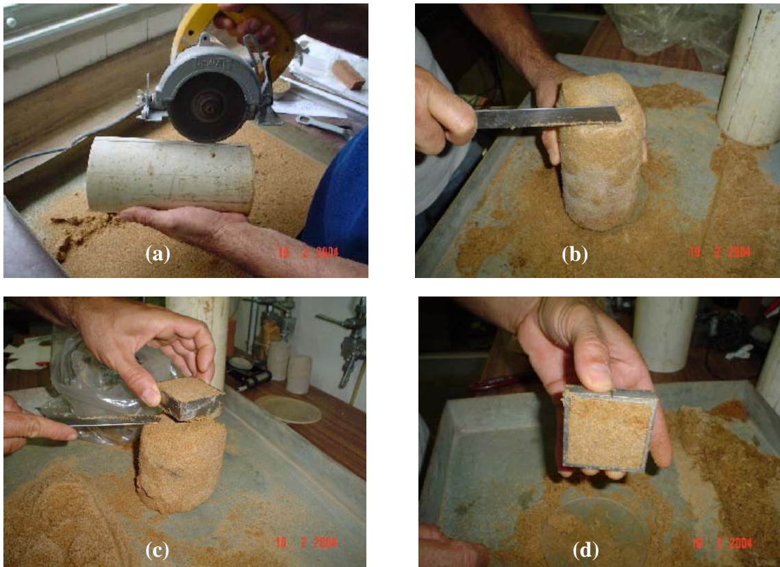
Figura 4.18: Preparação dos corpos de prova congelados: a) extração da amostra do tubo PVC; b) preparação inicial; c) raspagem com auxílio da espátula e do molde metálico; d) corpo de prova pronto
