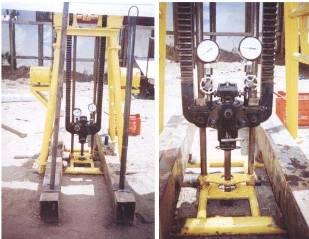
Figura 4.3: O equipamento de CPT da UFES: à esquerda, uma vista frontal onde se vêem as vigas de reação e o pórtico com a cremalheira; à direita, um detalhe do sistema de leitura de pressões durante a cravação
