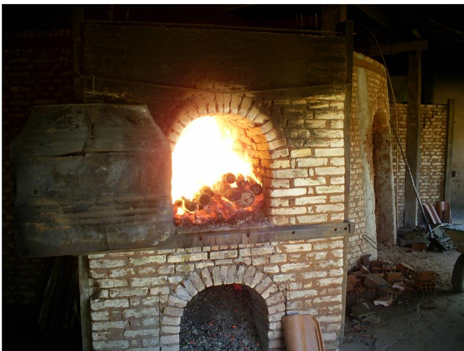
Figura 54: Entrada Frontal do Forno Abobada para Alimentação de Lenha.
