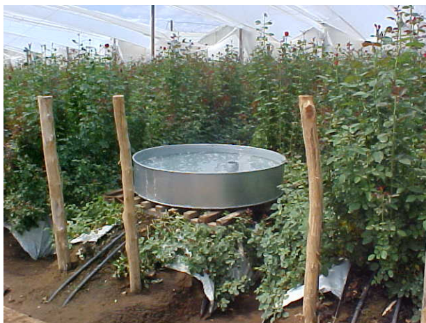
Figura 9. Detalhe da instalação do tanque Classe “A”
