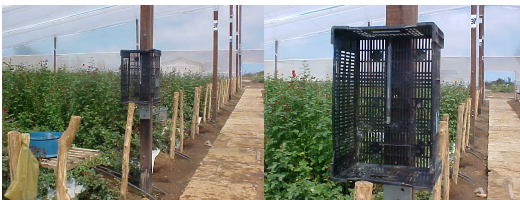
Figura 11. Detalhe da instalação do atmômetro de Piche
