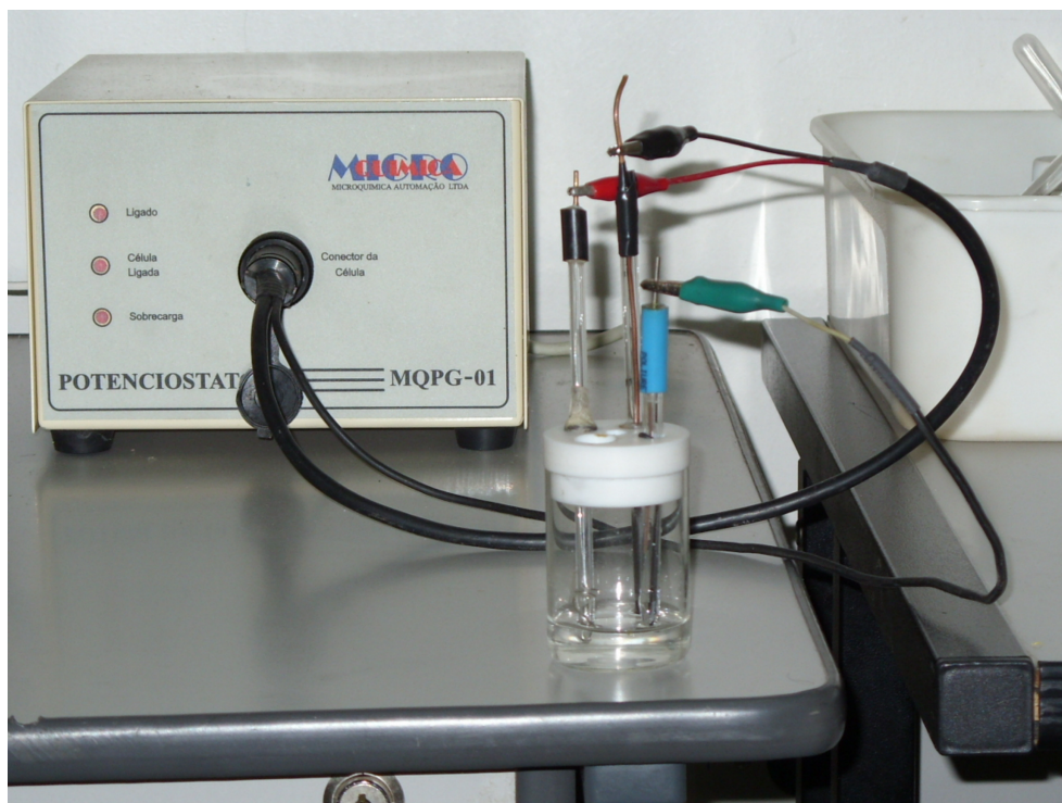
Figura 11. Sistema eletroquímico utilizado.
