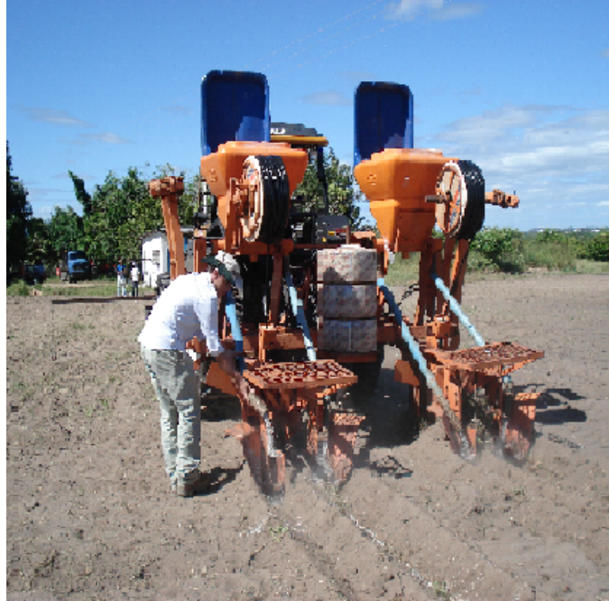
Figura 3 – Sulcador utilizado nas operações de sulcamento, adubação de plantio e instalação das linhas gotejadoras.
