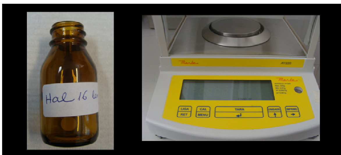
Figura 6 – (A) Frasco etiquetado para a colocação do espécime e (B) balança analítica utilizada para a pesagem dos espécimes.
