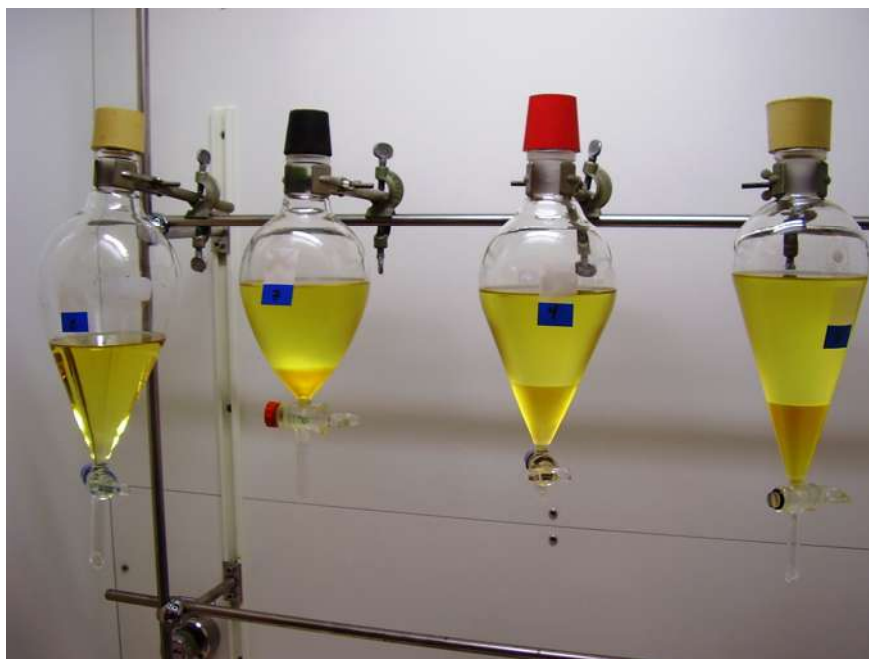
Figura 4.6. Biodiesel feito a partir de óleo de canola, etanol e KOH (separação das fases)
