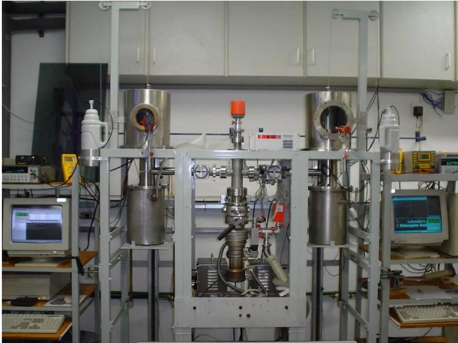
Figura 28 – Fotografia do Pêndulo de Torção
