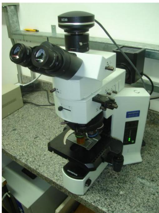
Figura 25 - Microscópio Óptico utilizado para a realização das micrografias.
