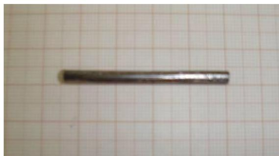
Figura 37 – Exemplo de amostra após o forjamento rotativo.
