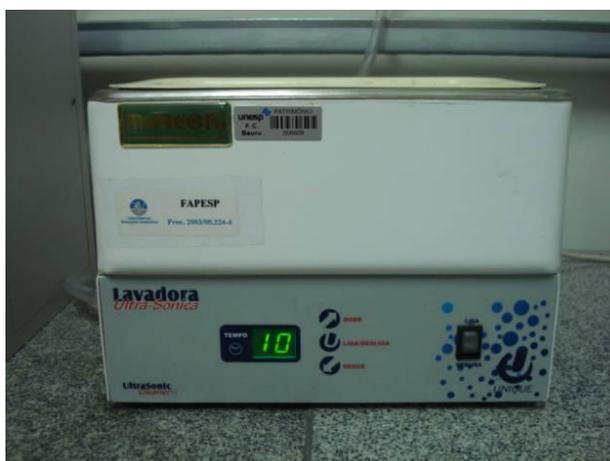
Figura 16 – Lavadora ultrassônica utilizada na limpeza dos metais usados na preparação das ligas.
