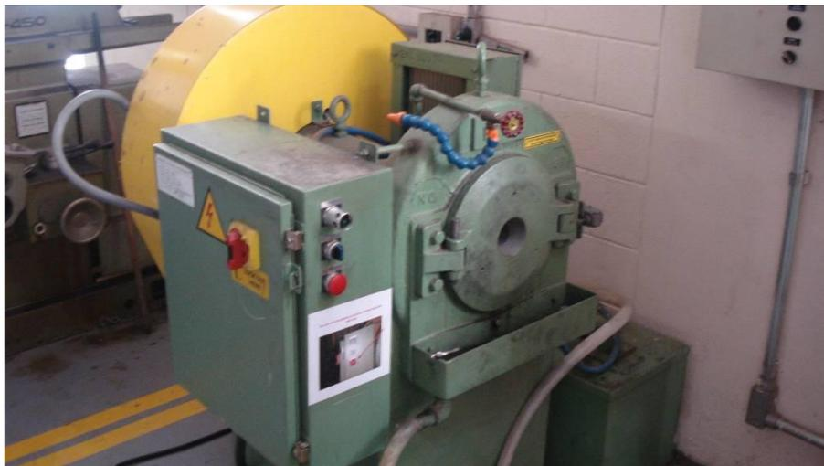
Figura 19 – Equipamento de forjamento rotativo utilizado na conformação das amostras.
