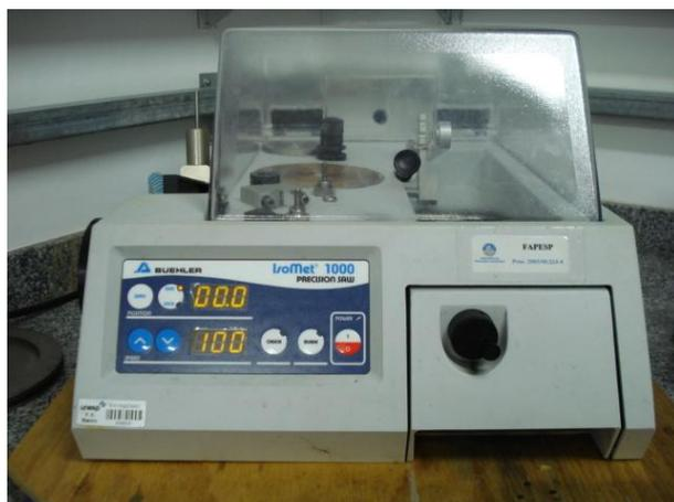
Figura 15 – Equipamento utilizado no corte dos metais usados na preparação das ligas.
