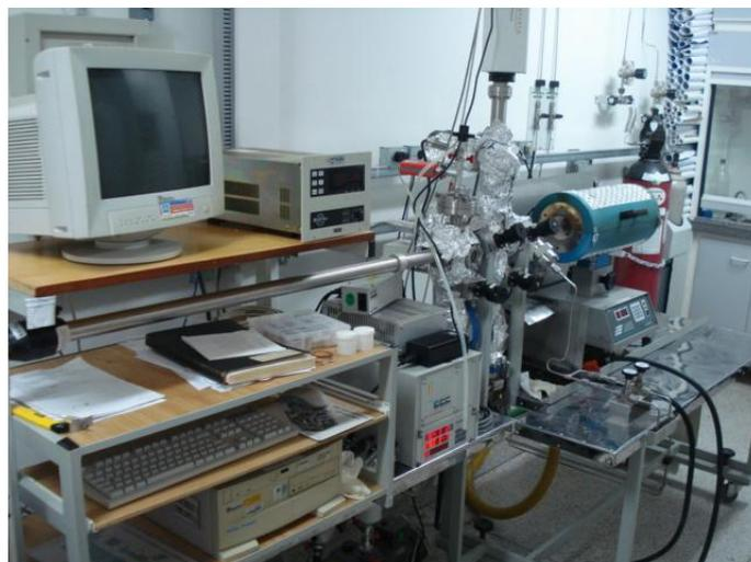
Figura 30 – Fotografia do sistema de Tratamentos Térmicos utilizado.
