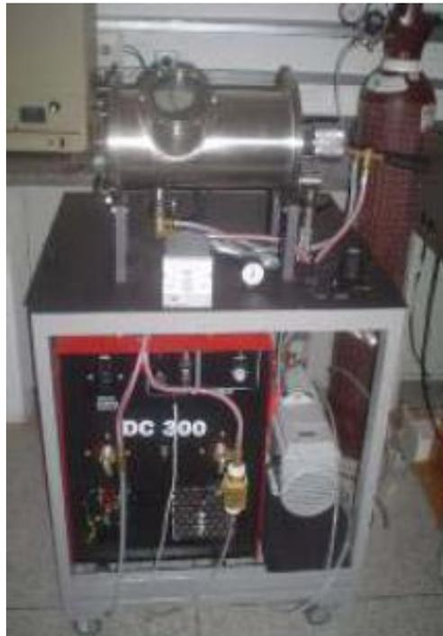
Figura 18 – Forno arco-voltaico utilizado na fusão das ligas.
