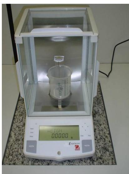
Figura 17 – Balança Analítica utilizada na medida de massa dos elementos de partida.
