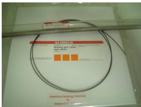
Figura 14 –Materiais de partida utilizados na fusão das ligas Ti-5%pNb e Ti-10%p.Nb.
