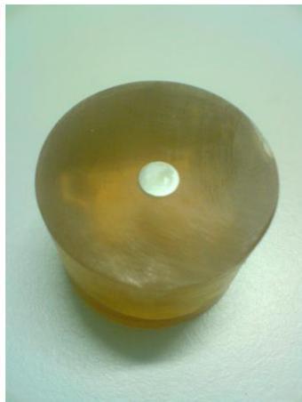
Figura 22 – Exemplo de amostra embutida em resina acrílica.
