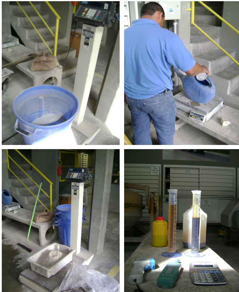
Figura 4.2 - Pesagem dos materiais utilizados na composição do concreto
