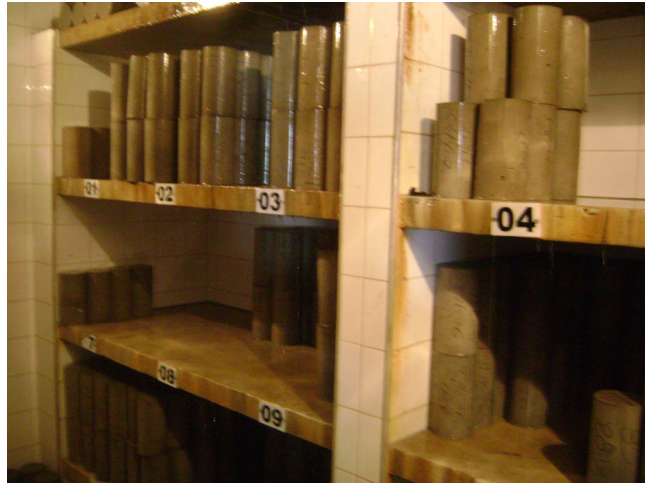
Figura 4.5 - Fotos dos corpos de prova armazenados em câmara úmida
