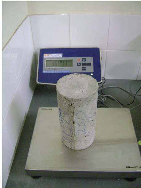
Figura 4.19 – Pesagem dos corpos de prova
