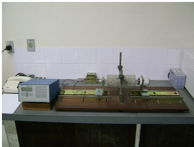
Figura 4.20 – Determinação do módulo de elasticidade dinâmico do concreto.
