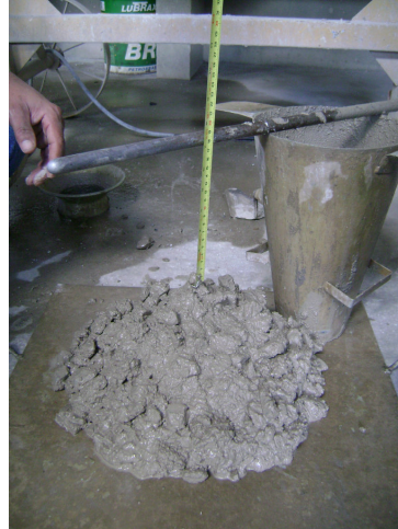
Figura 4.3 - Teste de abatimento do tronco de cone
