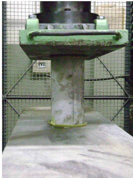
Figura 4.21 – Determinação da resistência à compressão.
