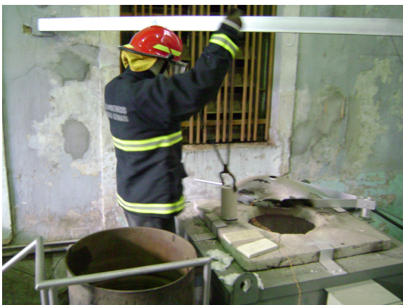
Figura 4.18– Retirada do corpo de prova do interior do forno e imersão em um galão contendo água para o resfriamento brusco.
