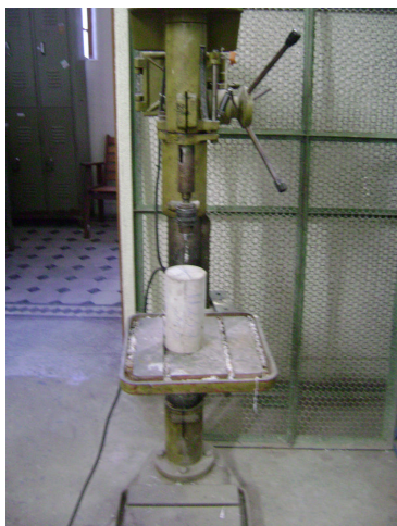
Figura 4.6 – Furação dos corpos de prova
