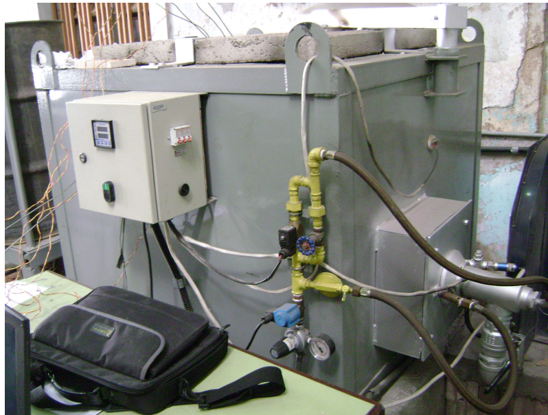
Figura 4.8 – Forno utilizado no aquecimento dos corpos de provas.
