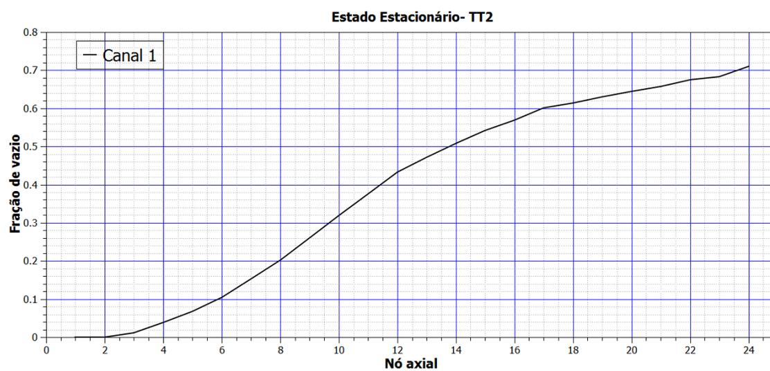
Figura 5.4. Fração de vazio axial para o canal 1.
