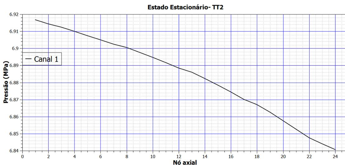
Figura 5.6. Distribuição da pressão axial para o canal 1.
