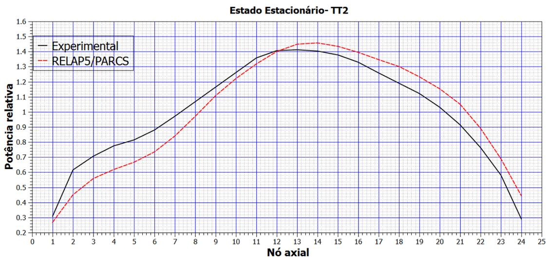
Figura 5.8. Distribuição de potência espacial do núcleo 2D (nível axial 12) e perfil de potência axial médio para o ponto TT2.
