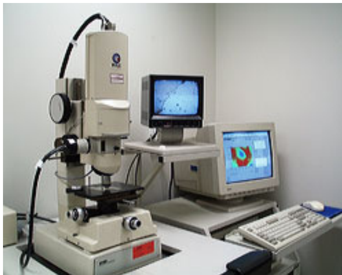
Figura 25 – Fotografia do interferômetro ótico utilizado na obtenção da rugosidade de superfícies dos filmes.
