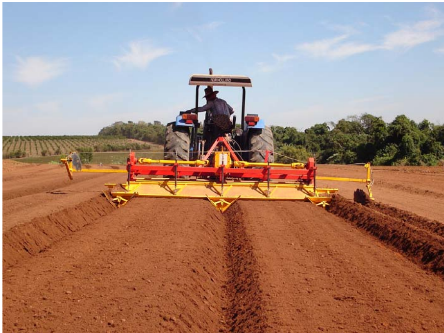
FIGURA 1 Fresadora encanteiradora utilizada no levantamento de canteiros. Foto: Consoni, 2010.
