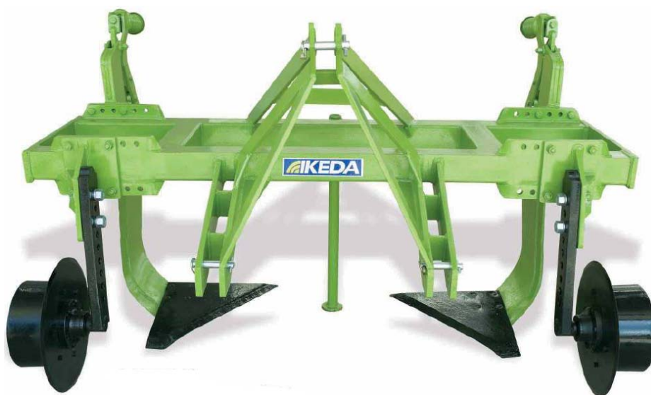
FIGURA 2 Modelo do afofador de solo utilizado na colheita. Fonte: IKDEA, 2010.
