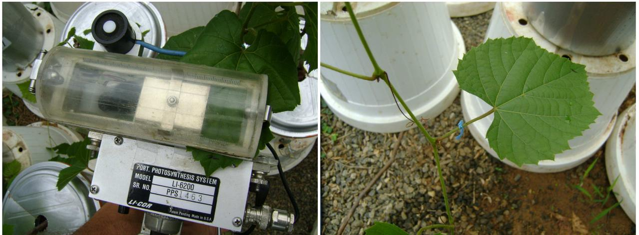
Figura 4. Analisador Portátil de Gás a Infravermelho (IRGA) e folha totalmente expandida marcada com o fio de lã azul.
