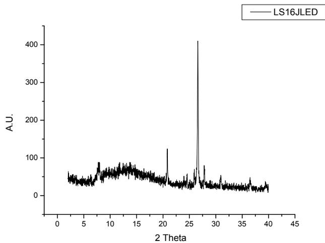
**Figura 6.** Difractograma da resina Filtek LS
