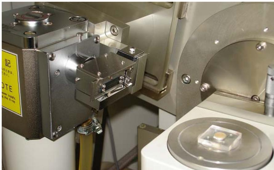
**Figura 5.** Equipamento XRD-7000 Schimatzu em funcionamento no GEPSI – Tecnopuc.
