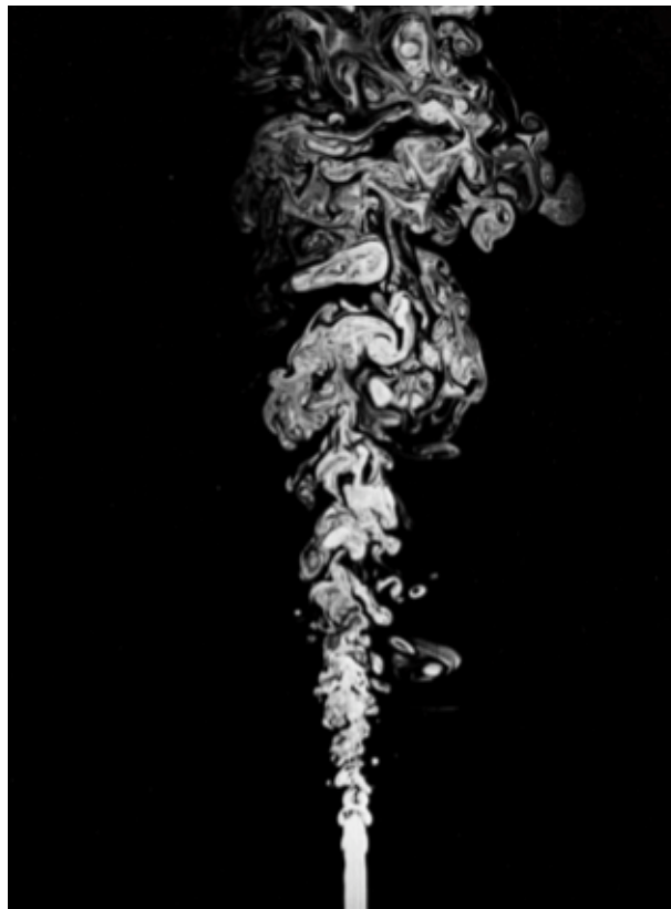
Figura 2.3: Exemplo de jato turbulento: escalas do movimento. Dimotakis, Lye e Papantoniou (1981)
