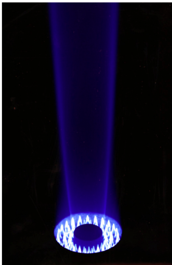
Figura 6.1: Chama D utilizada como padrão para validação de modelos de combustão. Apresentação da chama principal e das chamas pilotos, localizadas na região de “co-flow”. Fonte: site do Laboratório SANDIA
