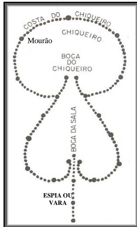
Croqui 04 – Planta baixa de um curral coração encontrado em menor quantidade na APA adaptado (In: Nery, Arian. 1995)
