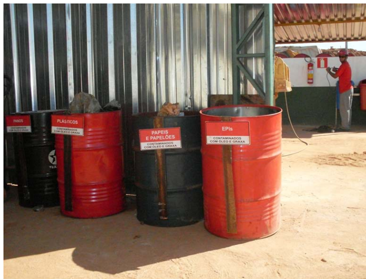
Figura 38: Tambores para armazenamento de resíduos contaminados na área da Oficina
