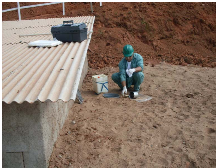
Figura 33: Monitoramento do efluente sanitário – coleta a jusante do filtro anaeróbio
