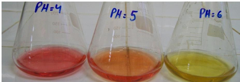
**FIGURA 14** - Mudanças de coloração do indicador vermelho de metila nas suas faixas de viragem de pH( 4 a 6 )
