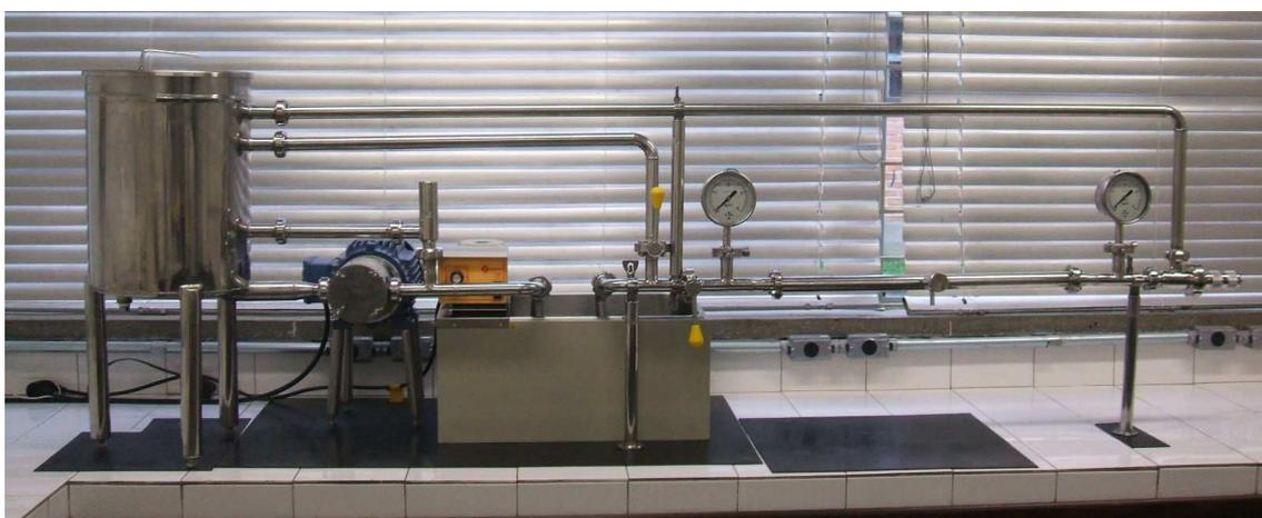
FIGURA 3.2 – UNIDADE EXPERIMENTAL DE MICROFILTRAÇÃO, EMULTEC – UFPR.
