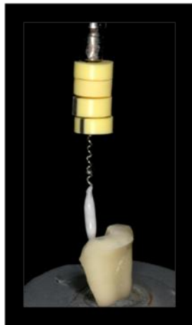
Fig. 4 Inserção da pasta de CaPE com a espiral lântulo.
