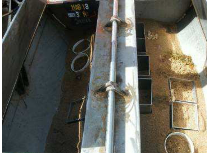
Figura 18: Instrumento de coleta das amostras de sedimento na foz
