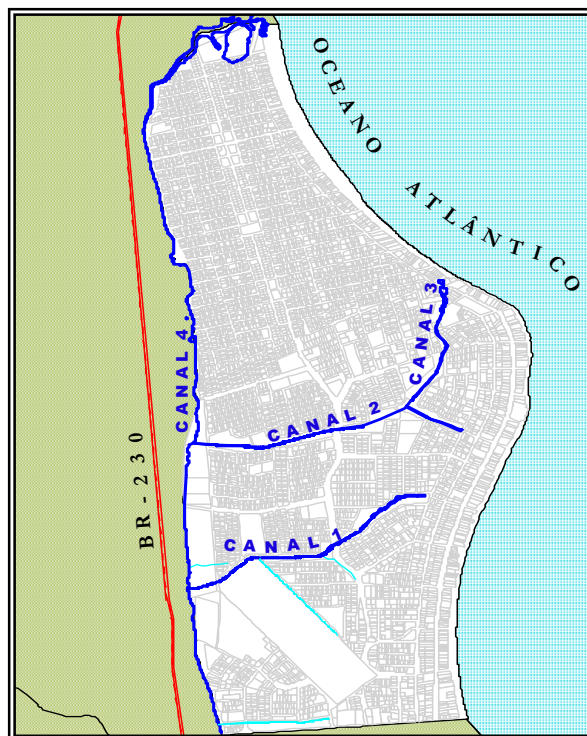
Figura 3.5 – Canais de macro – drenagem no bairro Bessa. Fonte: Nóbrega (2002).
