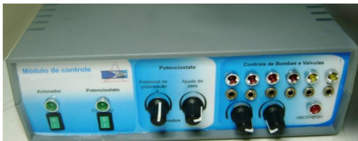
**Figura 41:** Módulo de controle utilizado no sistema fotométrico  $\mu$ FBA
