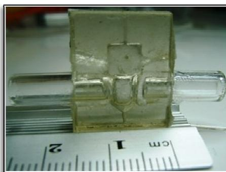
**Figura 68:** Selagem de um protótipo do  $\mu$ FBA com janelas formadas por tubos abertos em apenas uma das extremidades, possibilitando acoplamento de fontes diferentes de emissão e detecção. O material pode ser de vidro ou quartzo, dependendo da aplicação.
