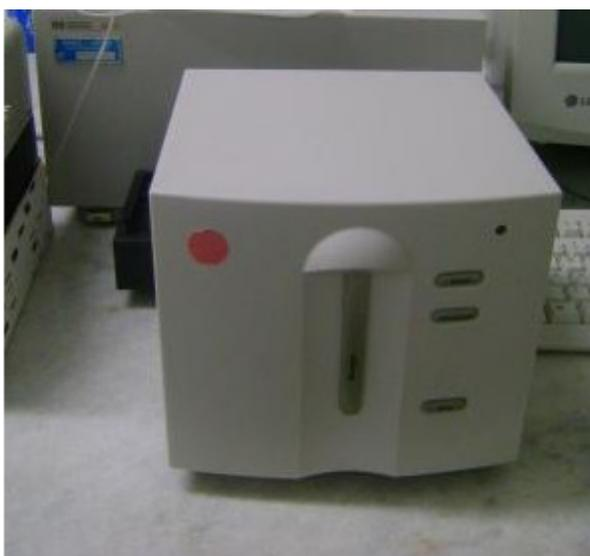
**Figura 42:** Espectrofotômetro HP 8453 utilizado para comparação com o sistema fotométrico  $\mu$ FBA
