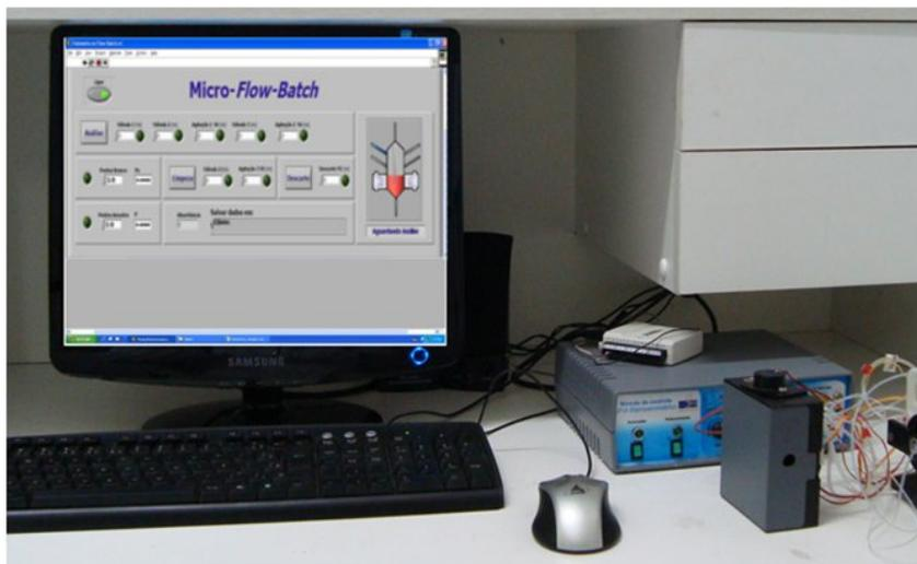
**Figura 65:** Foto do sistema  $\mu$ FBA em uso, a caixa onde se encontra a câmara de mistura, e detecção permanece fechada durante a operação. Observa-se a janela da interface gráfica de gerenciamento, desenvolvida em Labview® 5.1.
