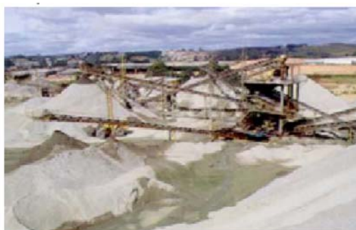
(c) Sistema de peneiramento para classificação do material.
