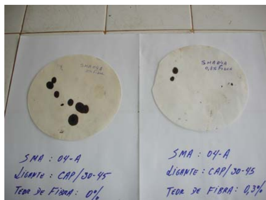
(b) Escorrimento, mistura 04-A.
