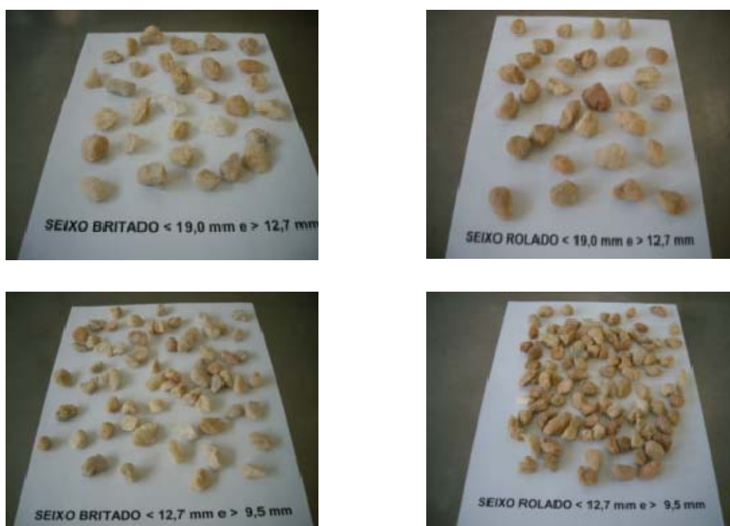
Figura 4.3: Fotos de fração de seixo, utilizados neste estudo.
