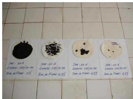
(d) Escorrimento, mistura 05-A.
