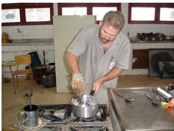
(c) Mistura Ligante-agregados
