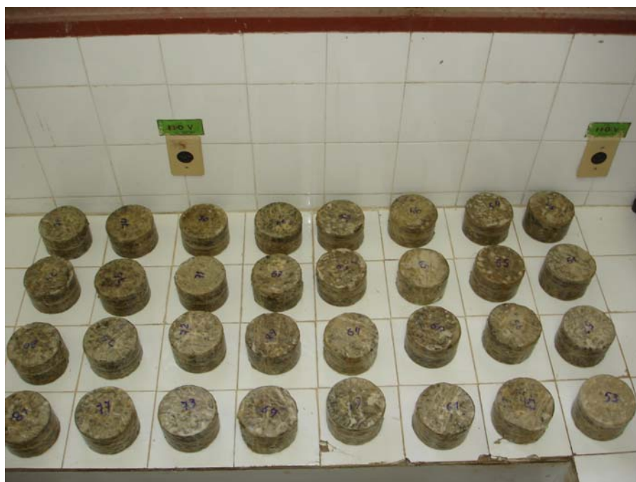
Figura 5.15: Corpos de prova com fita e parafina para determinação da densidade aparente
