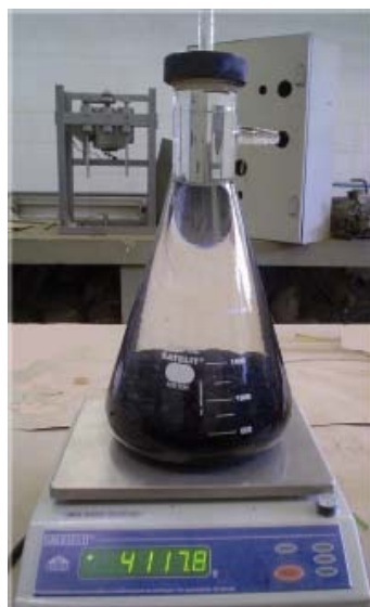
Figura 5.13: Determinação da massa do conjunto Kitassato – amostra durante ensaio DMM
