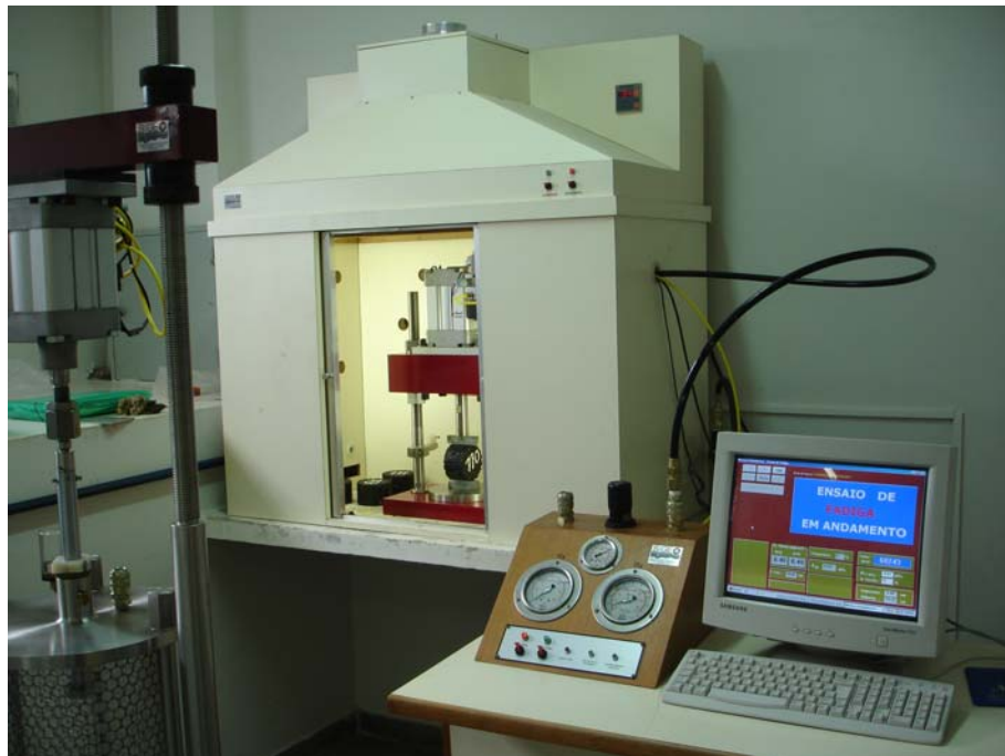
Figura 6.2: Equipamento de carga repetida para ensaio de compressão diametral do LEP/UFCG
