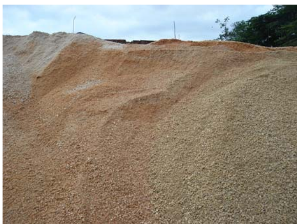
(a) Estoque de seixo, para confecção de CBUQ
