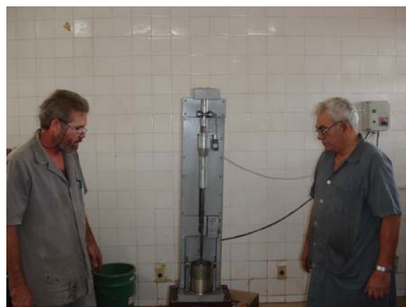
(d) Compactação do corpo de prova.
