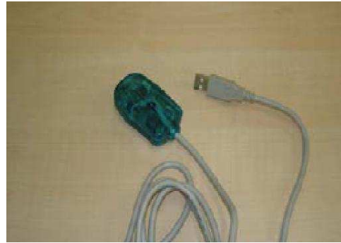
Figura 16: foto da interface que transfere dados do pingüim para computador
