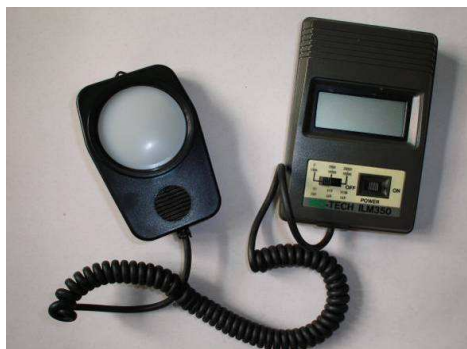
Figura 30: Luxímetro utilizado nas medições lumínicas
