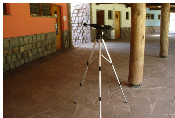
Figura 67: medidor de nível de pressão sonora, no momento das medições externas - circulação
