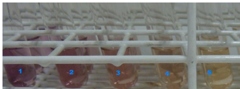
FIGURA 14 – AMOSTRAS DO EXTRATO METANÓLICO EM CONCENTRAÇÕES DE 1 A 5 µg/ml NO TESTE DE ATIVIDADE ANTIOXIDANTE COM O DPPH
