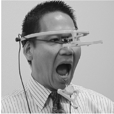
Figura 3.18: A captura de movimento realizada através do dispositivo JMA (ENCISO et al., 2003).
