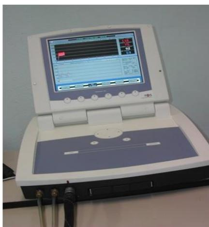
**Figura 3** – Fotopletismografia infravermelha digital (Finometer)
