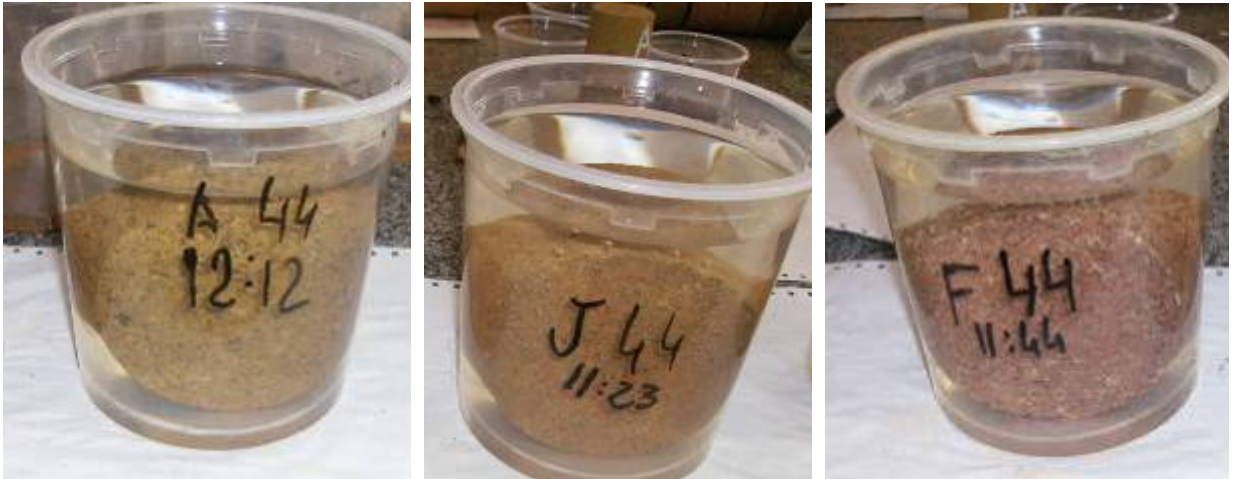
Figura 3. 24 – Detalhe dos CPs submetidos à submersão antes de ensaios de RTI.
