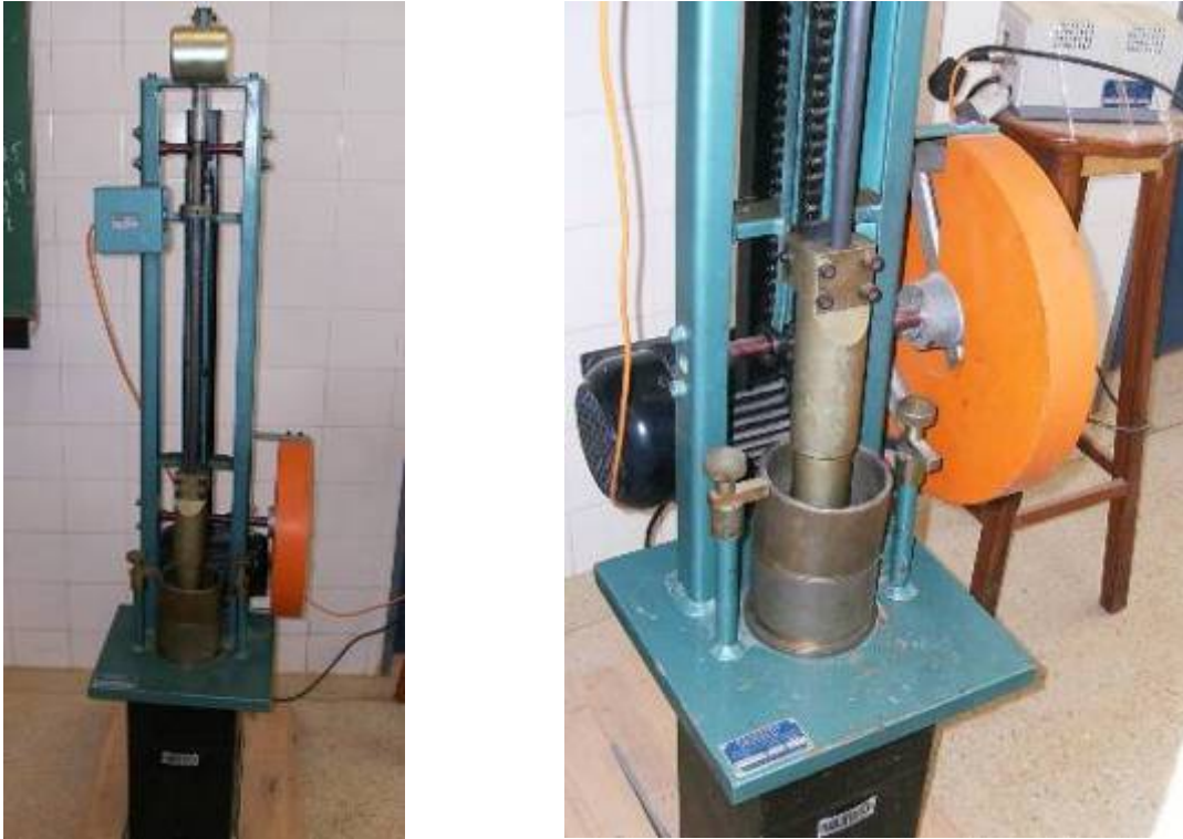
Figura 3. 23 – Compactador automático Marshall e detalhe do sistema de compactação utilizado na RTI.
