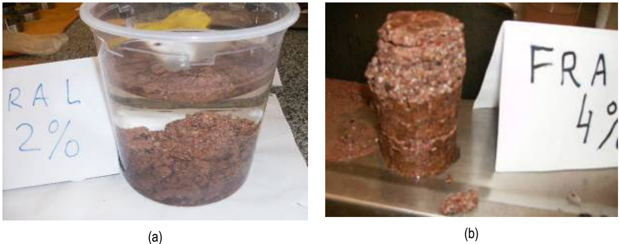
Figura 4.18 – Aspectos dos CPs desintegrados do solo FRAL com 2% (a) e 4% de emulsão (b).
