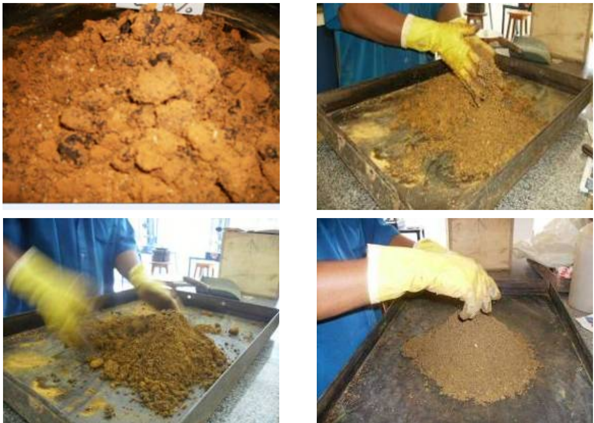
Figura 3. 15 – Fases de homogeneização manual da mistura.
