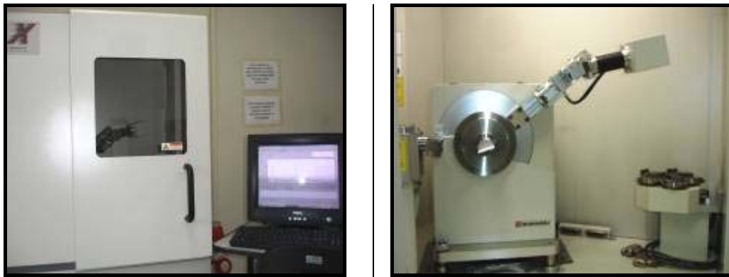
Figura 3. 18 – Equipamentos utilizados para realização do ensaio de DR-X (Fernandes, 2007).
