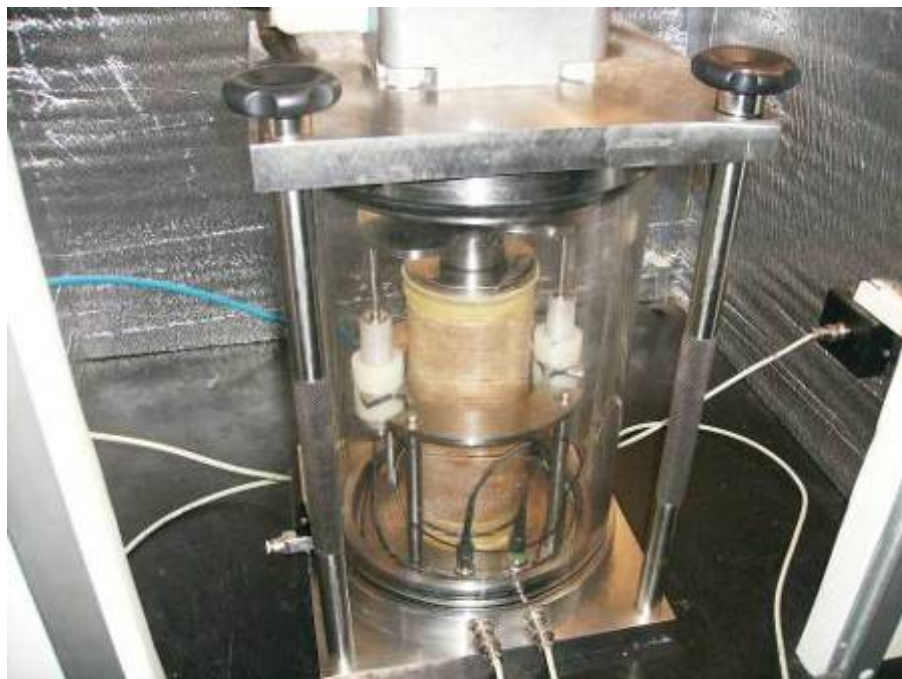
Figura 3. 32 – Acondicionamento do CP na câmara triaxial do SIEMBS.
