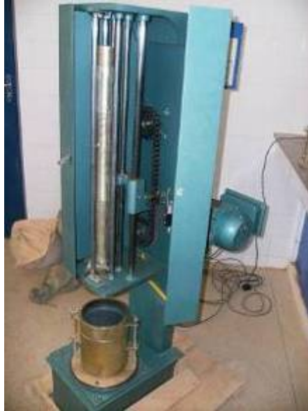
Figura 3. 17 – Compactador eletromecânico utilizado na compactação e ISC.
