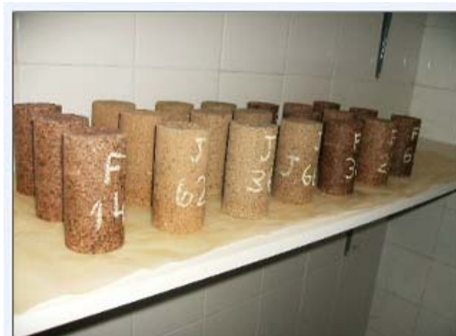
Figura 3. 20 - Acondicionamento dos CPs na câmara úmida para o processo de cura.
