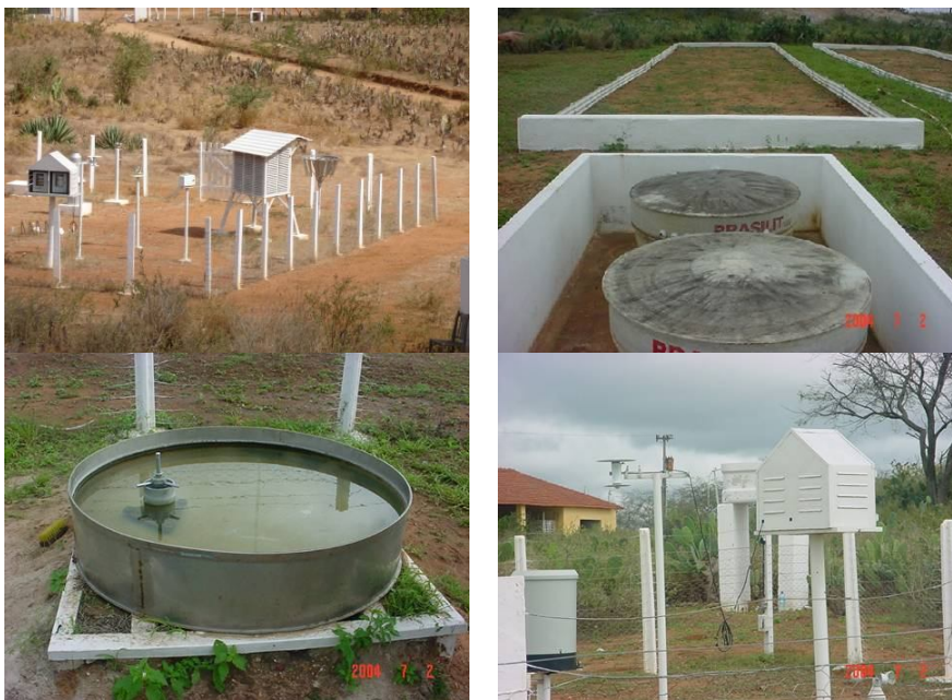
Figura 16 - Instrumentação da Bacia Escola
