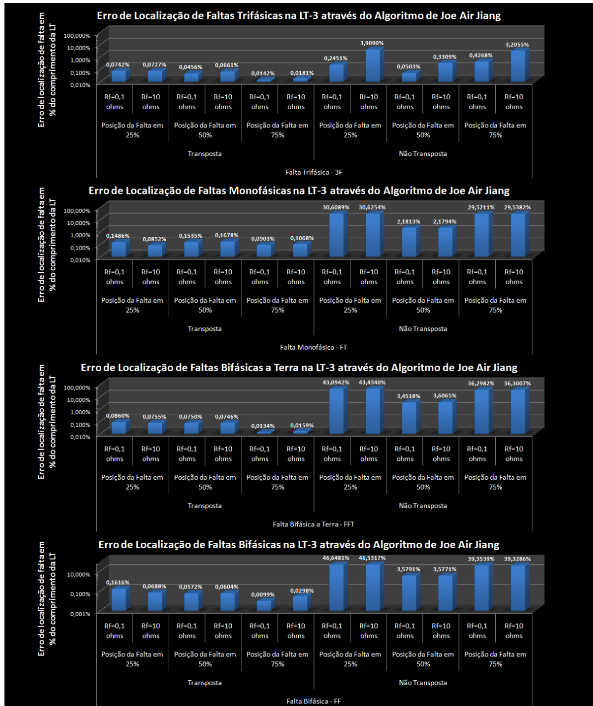
Figura 6.3 – Erro de Localização de Falta à 25%, 50% e 75% da LT em % do comprimento da LT para a LT-3 modelada na condição transposta e não transposta
