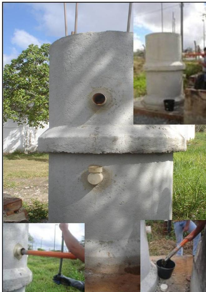
Figura 19: Obtenção das amostras do Lisímetro.
