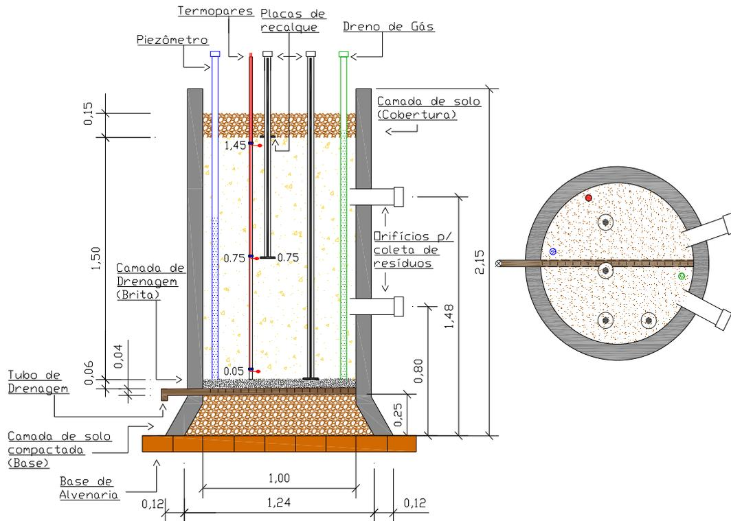
Figura 10: Desenho esquemático da célula experimental (Lisímetro) (LEITE, 2008).
