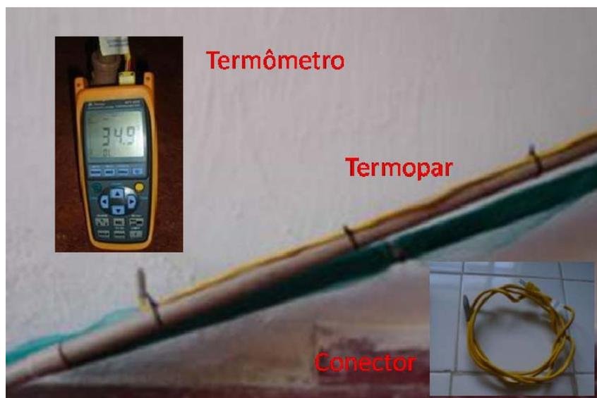
Figura 12: Termopar com conector tipo K e termômetro.
