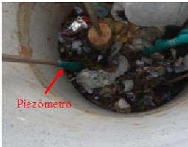
Figura 13: Instalação do piezômetro no lisímetro.
