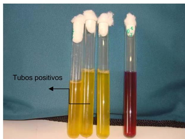
Figura 21: Tubos de ensaio presuntivo para coliformes totais.
