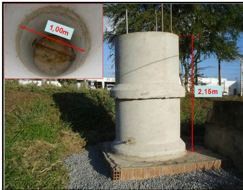
Figura 8: Célula experimental (lisímetro/biorreator)
