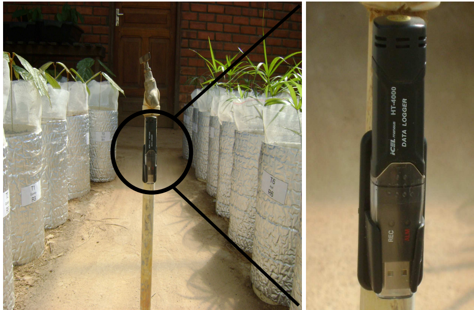
FIGURA 5 - Data logger posicionado entre os dois experimentos, na mesma altura das unidades experimentais.
