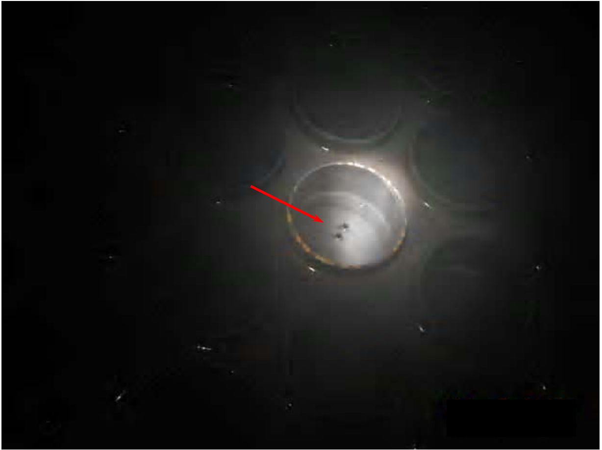
Figura 2.8 – A extremidade superior do tubo apresenta furos por pites (conforme destaque), bem como formação de anel com maior taxa de degradação na região de interface com o espelho.
