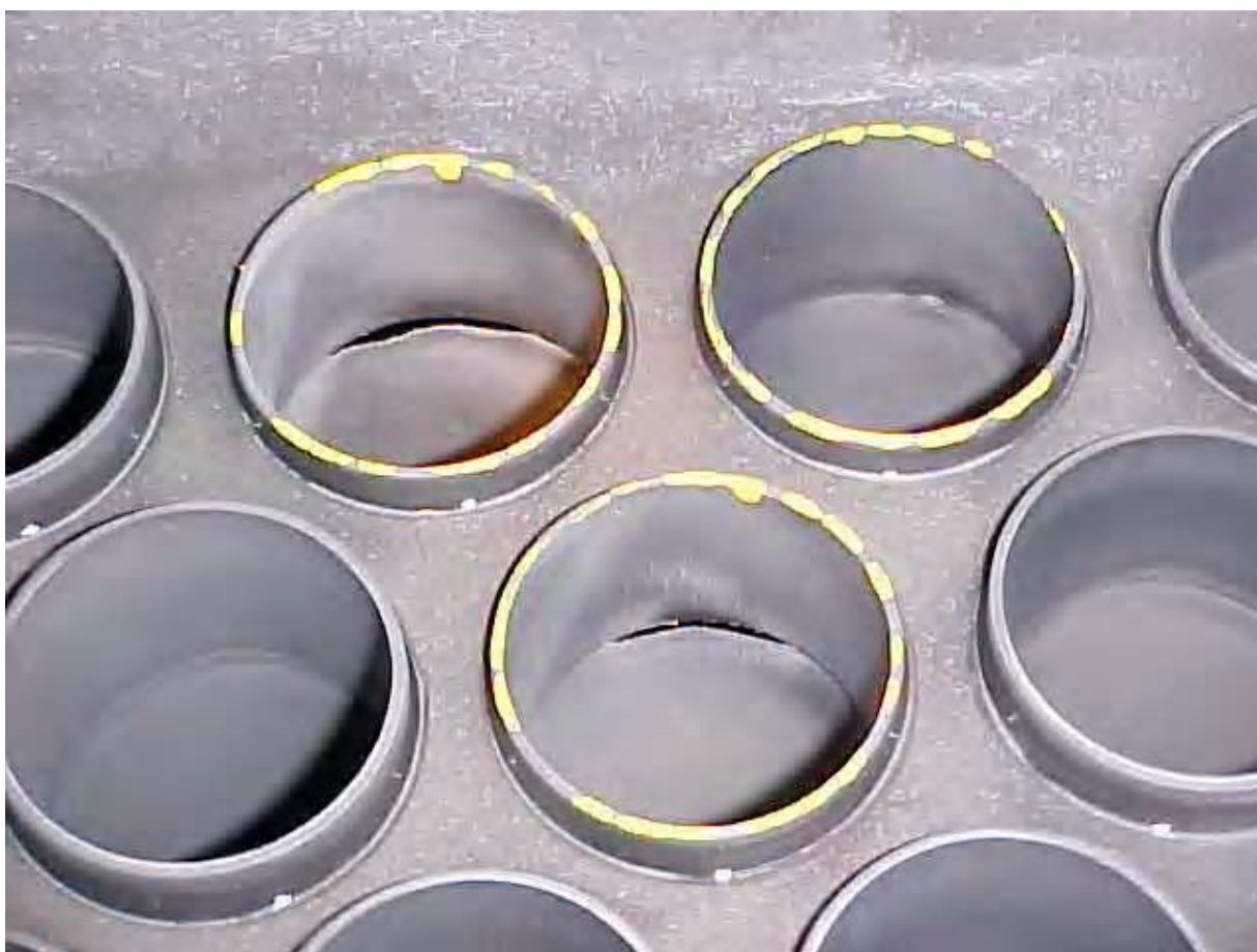
Figura 2.5 – Detalhe típico de inspeções realizadas na região do espelho superior dos trocadores de calor do 1° efeito depois da parada da planta por falha do mesmo.
