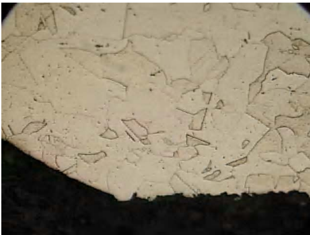
Figura 4.10 – Detalhe da figura 5.9. A parte direita da imagem mostra a superfície interna do tubo na região de corrosão generalizada, enquanto a parte esquerda mostra o ponto de corrosão localizada. Aumento 500x.
