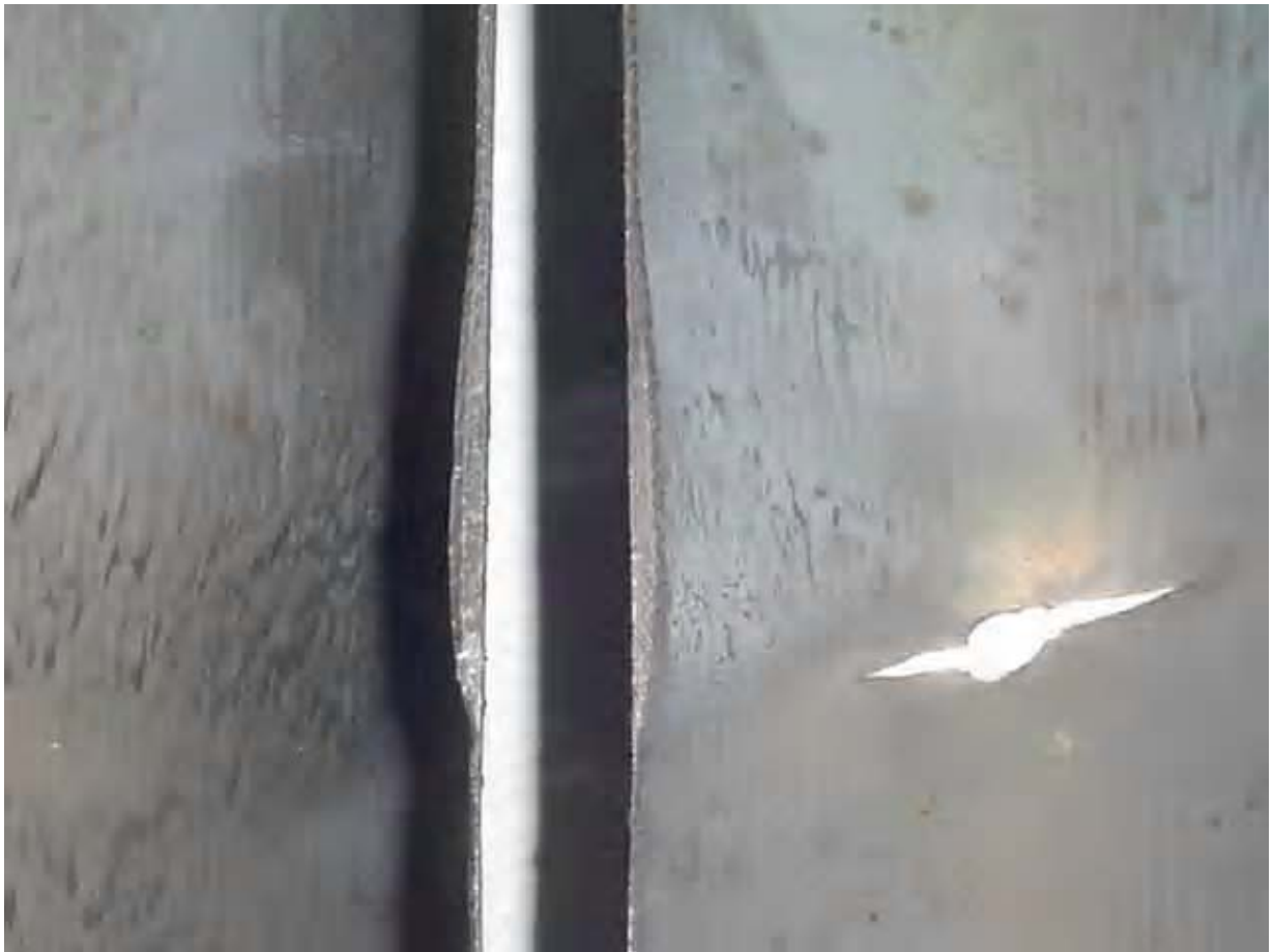
Figura 2.17 – Amostra de um tubo do trocador de calor da A-328 com falha na região da chicana. O tubo apresentou taxas de corrosão distintas na mesma posição vertical.
