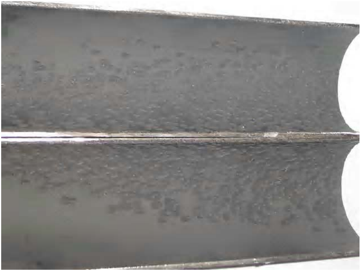
Figura 2.9 – Tubo do trocador de calor do 1º efeito da A-328 que apresentou processo de formação de pites generalizados.
