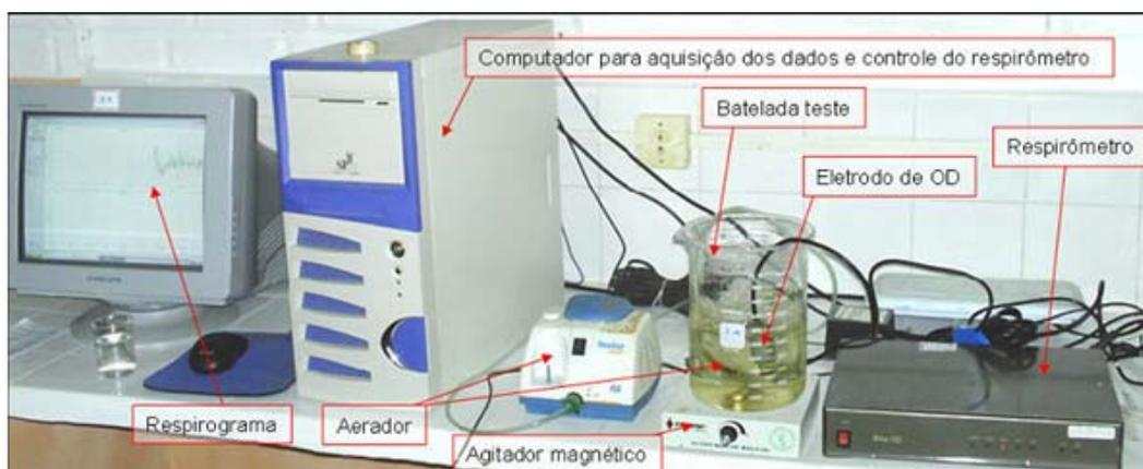
**Figura 2.10** - Esquema do sistema montado para realizar os testes respirométricos.
