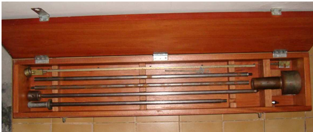
Figura 3.13– Cone de Penetração Dinâmica utilizado na pesquisa.
