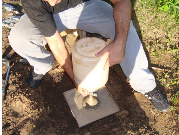
Figura 3.11 – Execução do ensaio com Frasco de Areia.
