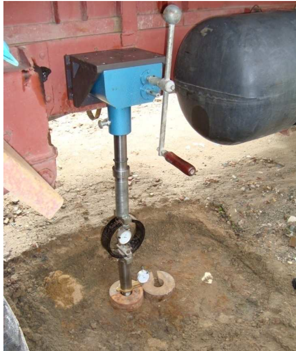
Figura 2.19 – Execução do ensaio de CBR “in situ”
