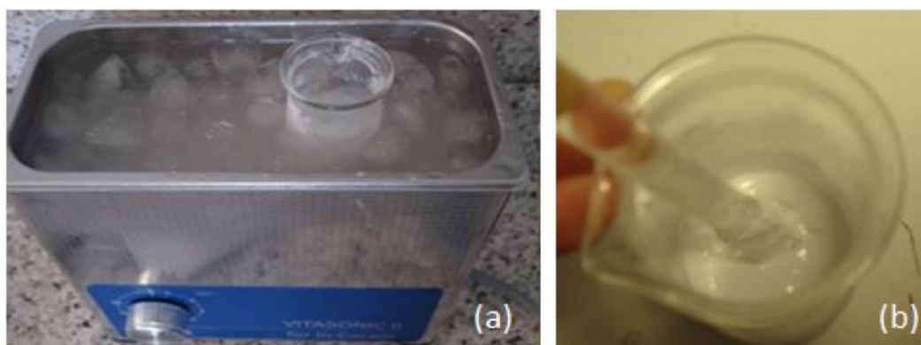
Figura 5. (a) Alumina homogeneizada em pote de vidro; (b) Barbotina ao sair do ultra-som
