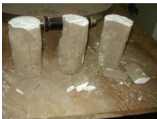
Figura 10 f. Corpos-de-prova com resíduos de granito rompidos.
