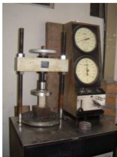
Figura 10 d. Rompimento dos corpos-de-prova.
