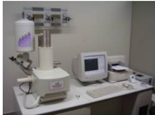
Figura 12 b. Equipamento de MEV com EDS acoplado.
