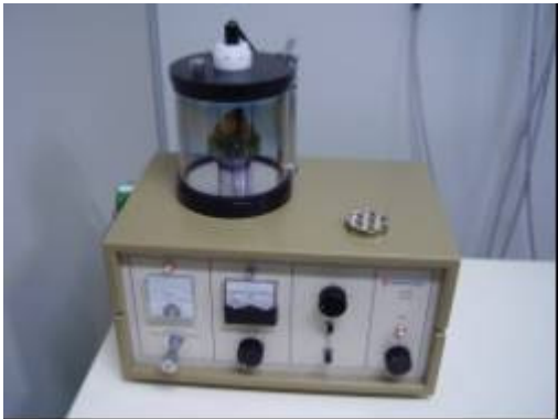
Figura 12 a. Recobrimento da amostra com ouro.
