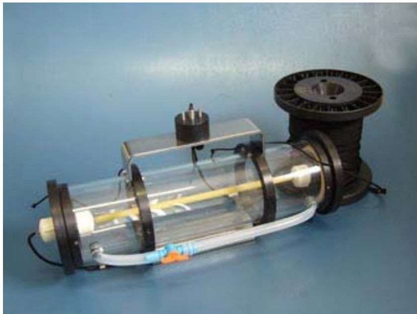
Figura 3.3. Garrafa van Dorn utilizada nas coletas de água.
