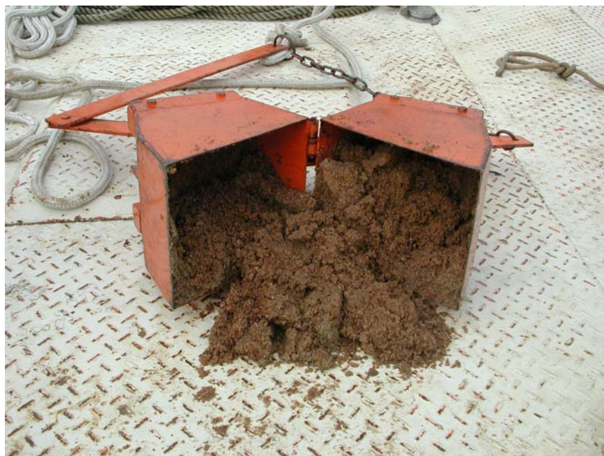
Figura 3.2. Draga tipo van Veen com amostra de sedimento
