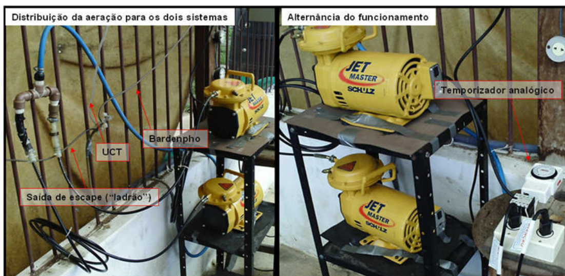
Figura (3.6): Fotografia dos compressores de ar e a configuração da tubulação de distribuição de ar para os sistemas.
