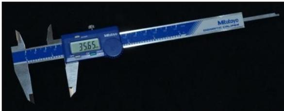
FIGURA 19 - Paquímetro digital
