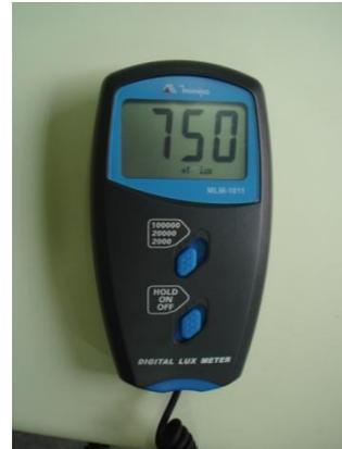
FIGURA 3- Mensuração da iluminação. FIGURA 4 - Iluminação na faixa de 750lux.
