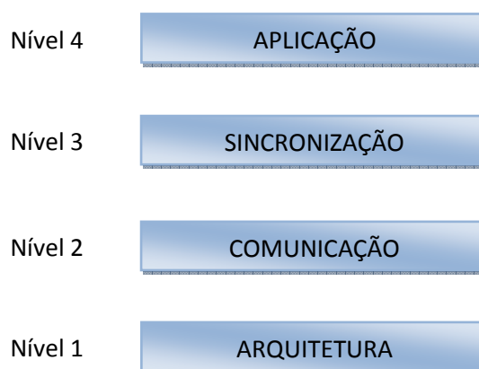
Figura 5.1 - Estrutura de um ambiente de Simulação Distribuída
