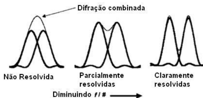
Figura 3.8: Intensidades combinadas para dois pontos em função de f-number .
