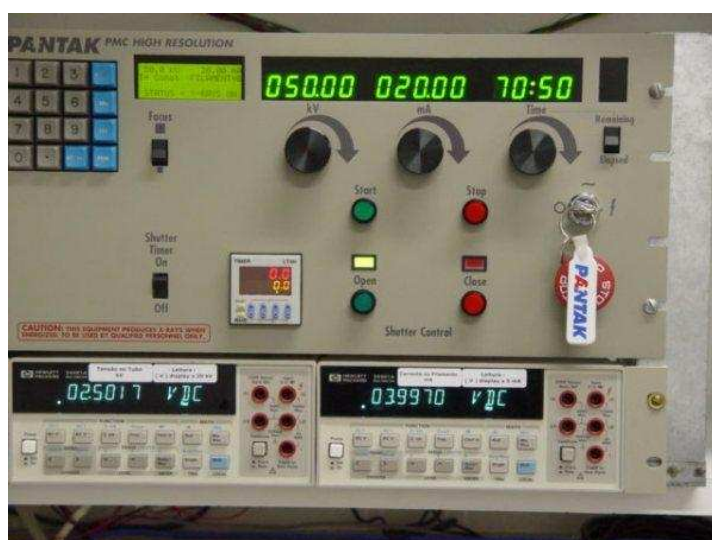
Figura III. 1: Painel do tubo de raios X do LNMRI/IRD/CNEN. É um equipamento industrial adaptado para uso em metrologia das radiações ionizantes. Os valores de tensão e corrente podem ser ajustados manualmente e conferidos, respectivamente, pelos multímetros acoplados ao tubo. A corrente no tubo para este trabalho foi fixada em 10 mA, a fim de obter valores de kerma no ar próximos aos usados nas clínicas odontológicas.
