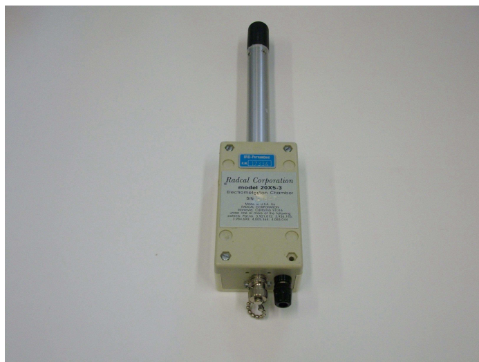
Figura III. 2: Câmara de ionização padrão nacional pertencente ao LNMRI/IRD/CNEN, rastreada ao Laboratório Primário alemão PTB.
