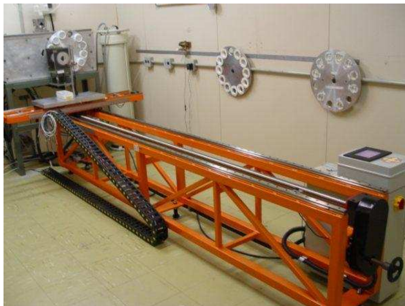
Figura III. 8: Configuração da instalação de medição do LNMRI/IRD/CNEN. A instalação é constituída de uma mesa fixa automatizada com movimento em dois graus de liberdade, colimadores fixos à saída do tubo de raios X, rodas de filtros atenuadores de elevada pureza certificada.
