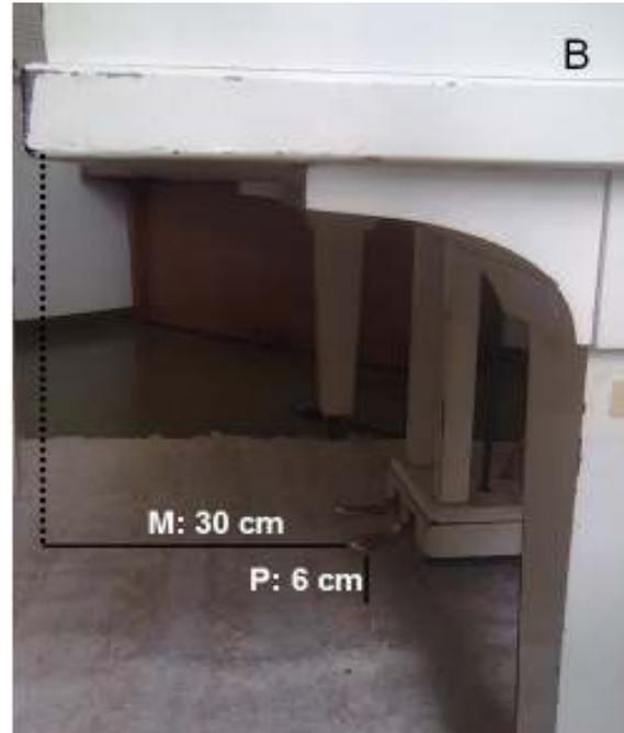
Figura 1.9b: Medidas do piano Essenfelder 36.104: - extremidade anterior ao início do pedal (M); - altura do pedal (P).
