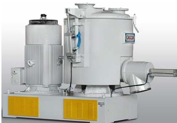
Figura 3-4. Misturador intensivo.
