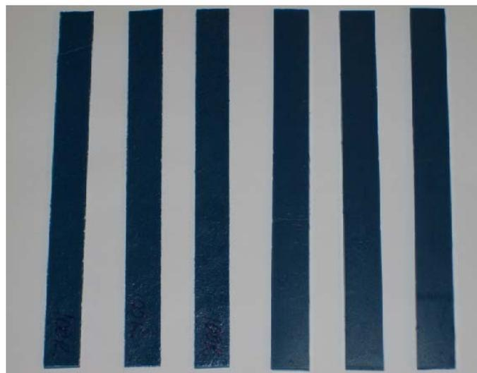
Figura 3-8. Corpos de prova das amostras de rotomoldado.
