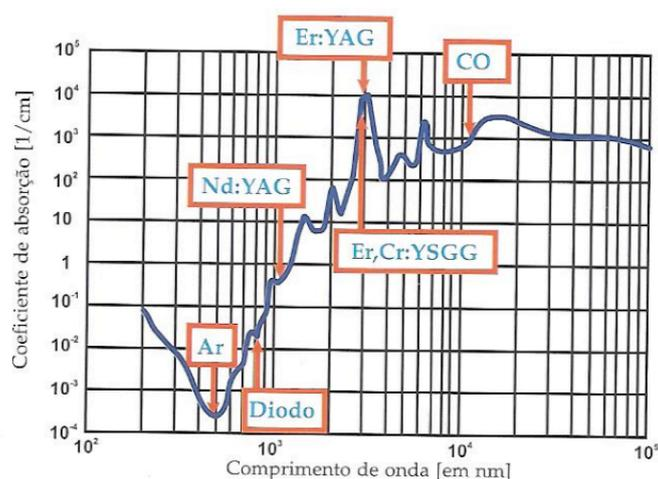
**FIGURA 3** - Espectro absorção água/comprimento de onda dos lasers.\*\*\*
