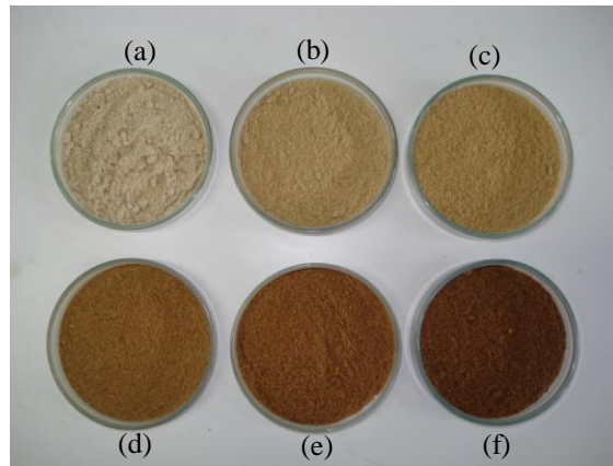
Figura 16 – Farelos de arroz (cultivar BRS Sertaneja) torrados durante 0 min (a), 6 min (b), 9 min (c), 12 min (d), 15 min (e) e 18 min (f).
