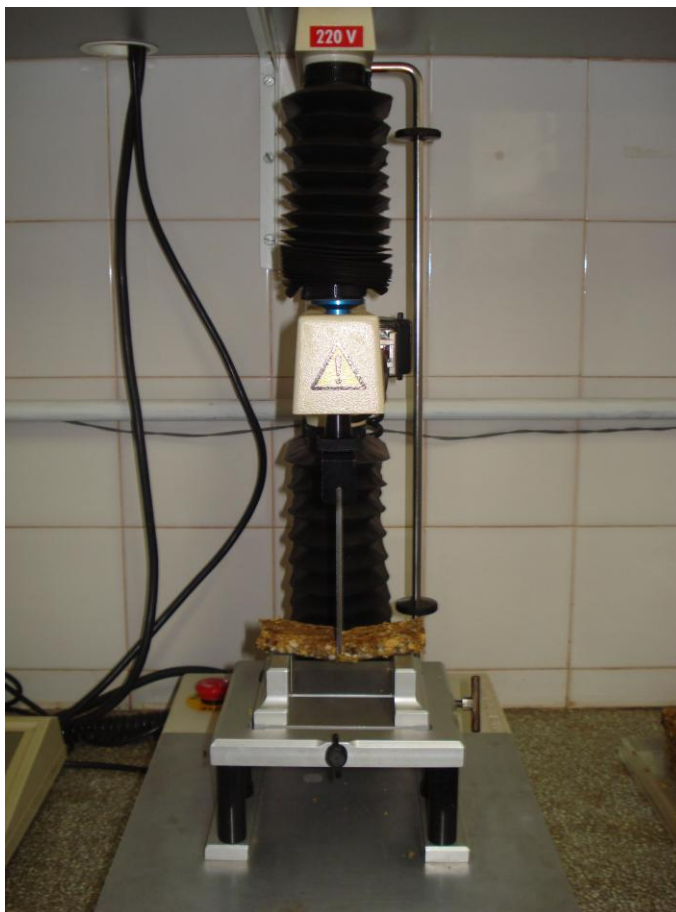
Figura 10 – Análise de força de ruptura das barras de cereais.
